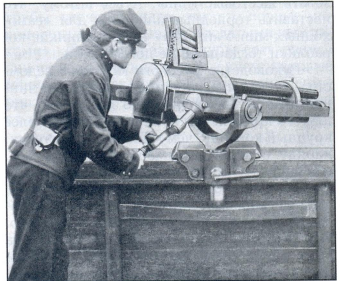
37-мм пятиствольная пушка – одно из основных орудий «противоминной артиллерии», созданной специально для борьбы с миноносцами
